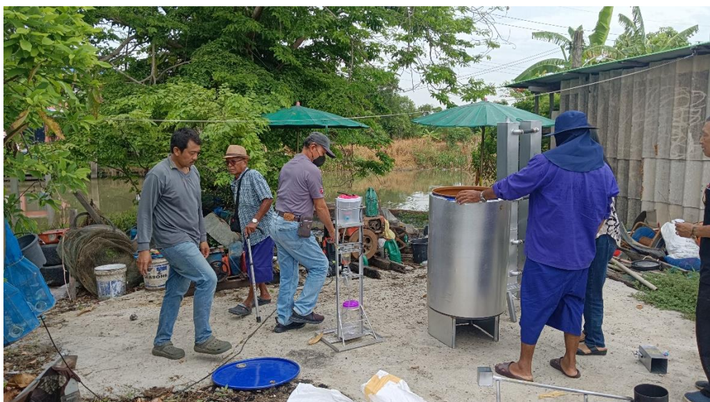
การออกแบบและสร้างหน่วยเครื่องมือระบบหอกลั่นอย่างง่ายโดยที่ชุมชนสามารถทำขึ้นใช้เองได้
