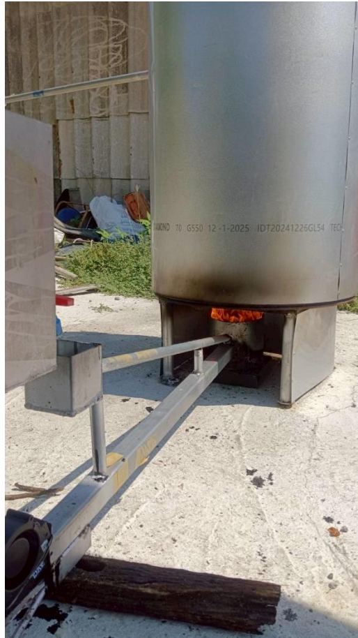
การผลิตน้ำมันจากขยะพลาสติกด้วยกระบวนการไพโรไลซิสด้วยระบบหอกถ่าน
