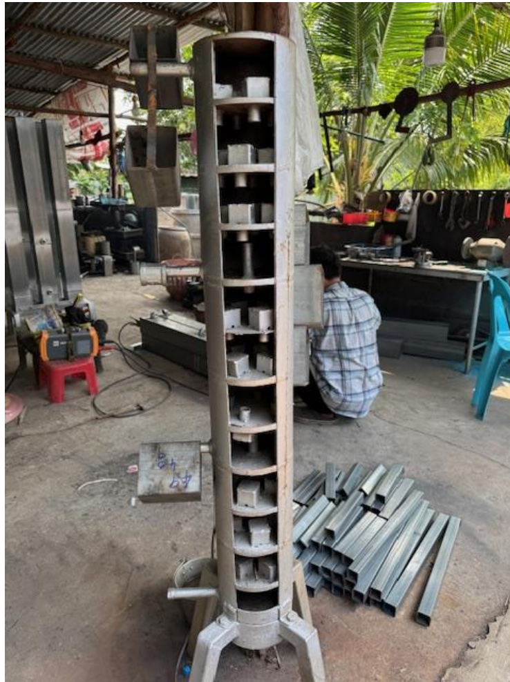
การออกแบบและสร้างหน่วยเครื่องมือระบบหอกลั่นอย่างง่ายโดยที่ชุมชนสามารถทำขึ้นใช้เองได้
